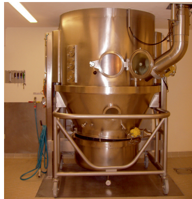
Abb. B 2: Wirbelschichtanlage, teildemontiert zur Reinigung. (Quelle: F. Stieneker)
