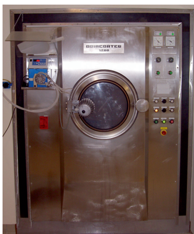
Abb. B 1: Typischer Coater (Driacoater 1200). (Quelle: F. Stieneker)
